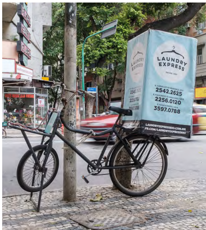
Bicicleta tipo Short John adaptada para el transporte de ropa desde los servicios de limpieza.
